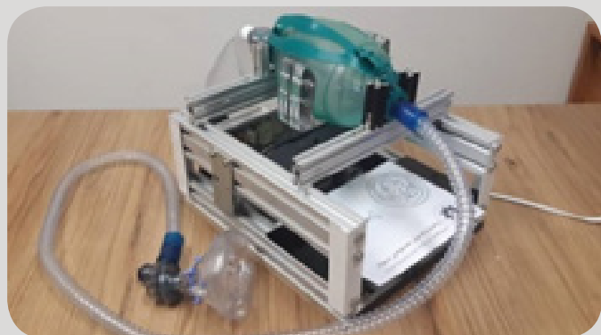
دستگاه تنفس مصنوعی برای بیماران مبتلا به ویروس کرونا توسط پژوهشگران دانشگاه تهران
